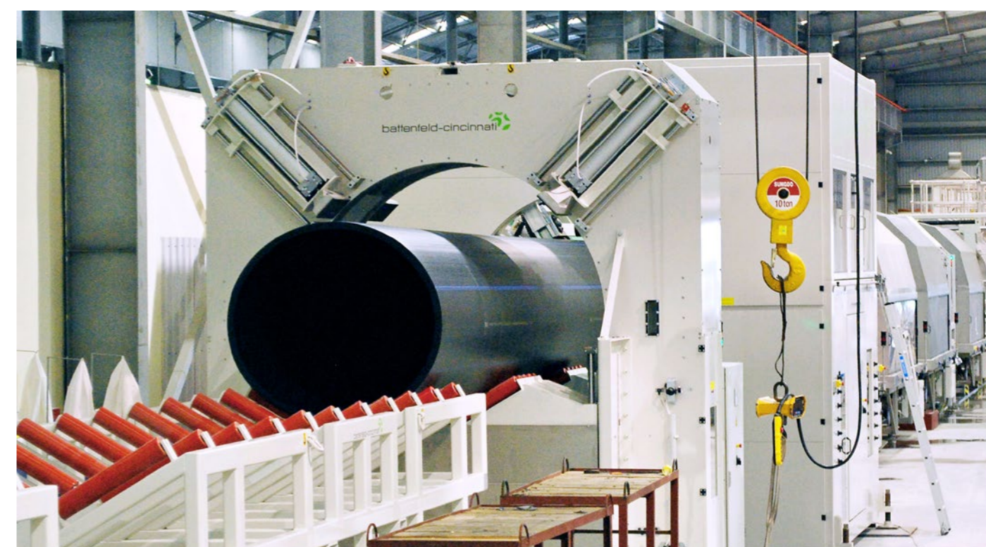
Dây chuyền sản xuất ống HDPE DN 2.000mm HDPE DN 2,000mm production line
